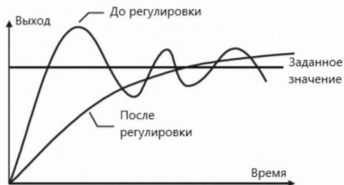
Рисунок 6-20. Подавление колебаний на выходе ПИД-регулятора
